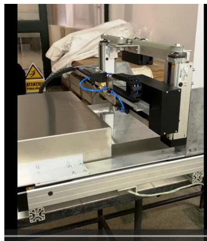
Fig. 5 Depunere straturi nanostructurate cu proprietăți antibacteriene și de autocurățare
