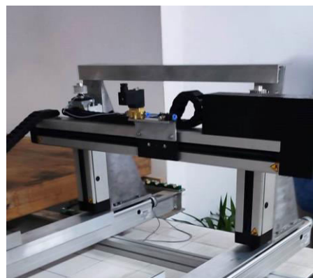
Fig. 3 Faze tehnologii de depunere a nanostraturilor de TiO 2 mezoporos pe sticlă A4 - echipament de depunere (printare)
