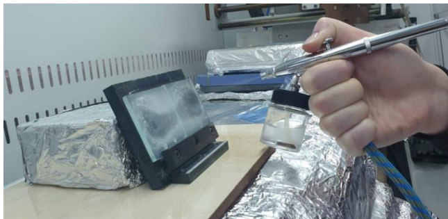
Fig. 2 Faze tehnologii de depunere a nanostraturilor de TiO 2 mezoporos pe sticlă A4 - în laborator
