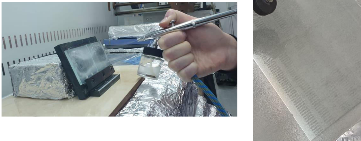
Fig. 1 Tehnologie de depunere a nanostraturilor de \text{TiO}_2 mezoporos pe sticlă
