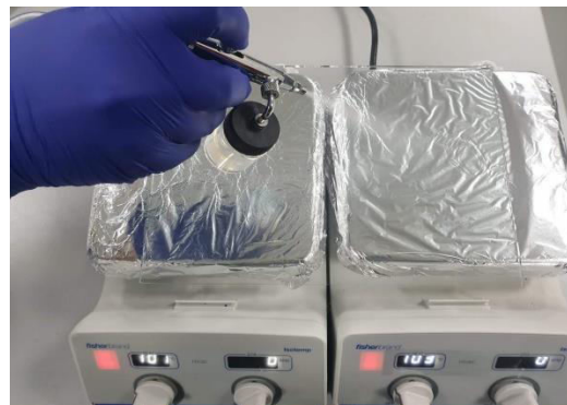
Fig. 2 Faze tehnologii de depunere a nanostraturilor de TiO 2 mezoporos pe sticlă A4 - în laborator
