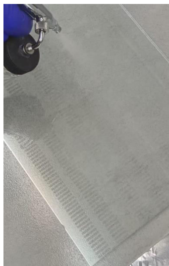
Fig. 7 Depunere straturi nanostructurate de \text{TiO}_2 mezoporos pe sticlă
